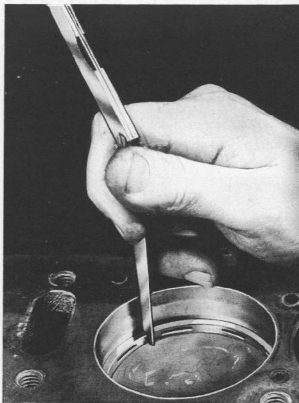
FIG. 34—PISTON RING GAP
